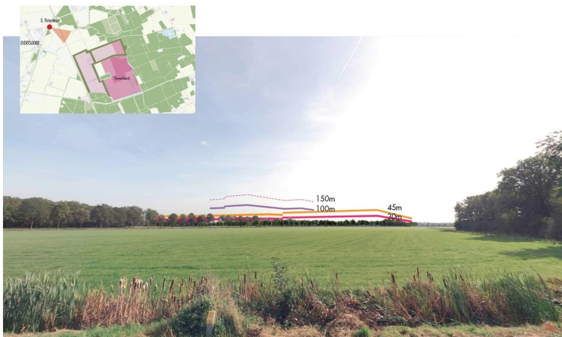
Afbeelding 17 Hoogtelijnen maximale bouwmogelijkheden nieuwe ontwikkeling Patersstraat
