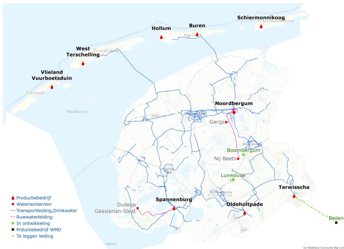
Figuur 1.1. Huidige drinkwaterwinningen en distributienetwerk (hoofdleidingen).
