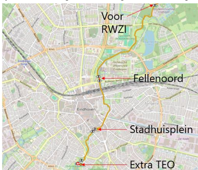
Figuur 10 TEO-systemen die zijn opgenomen in de modelleringen; de "oogjes" zijn meetpunten in het model
