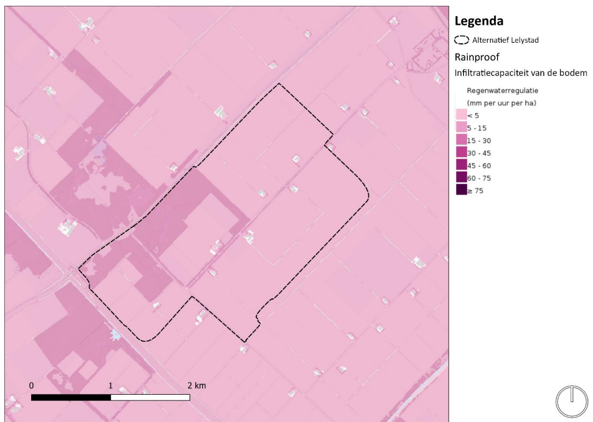
Figuur 2.20: Infiltratie in mm per uur per ha – Locatie Lelystad
