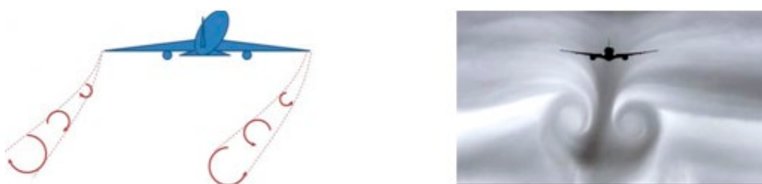
Figuur 30: De dubbele vortex achter een vliegtuig (links schematisch, rechts in een werkelijke situatie).
