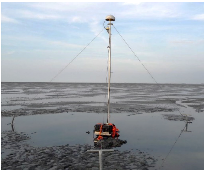
Figuur 6: Meetopstelling jaarlijkse GNSS monitoring
