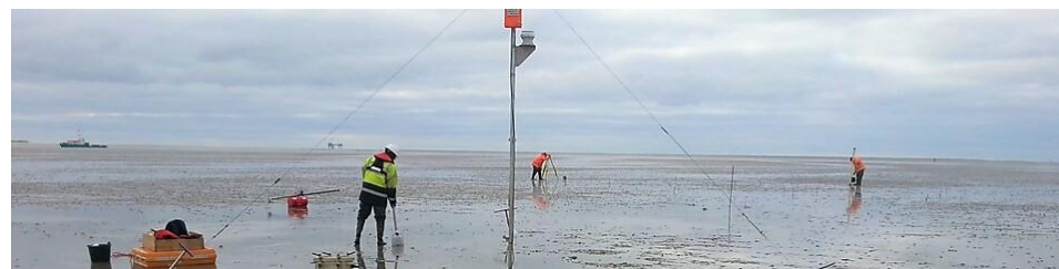
Figuur 3-2 Opbouw van een tijdelijk GPS-meetstation op de Ballastplaat in de Waddenzee.
