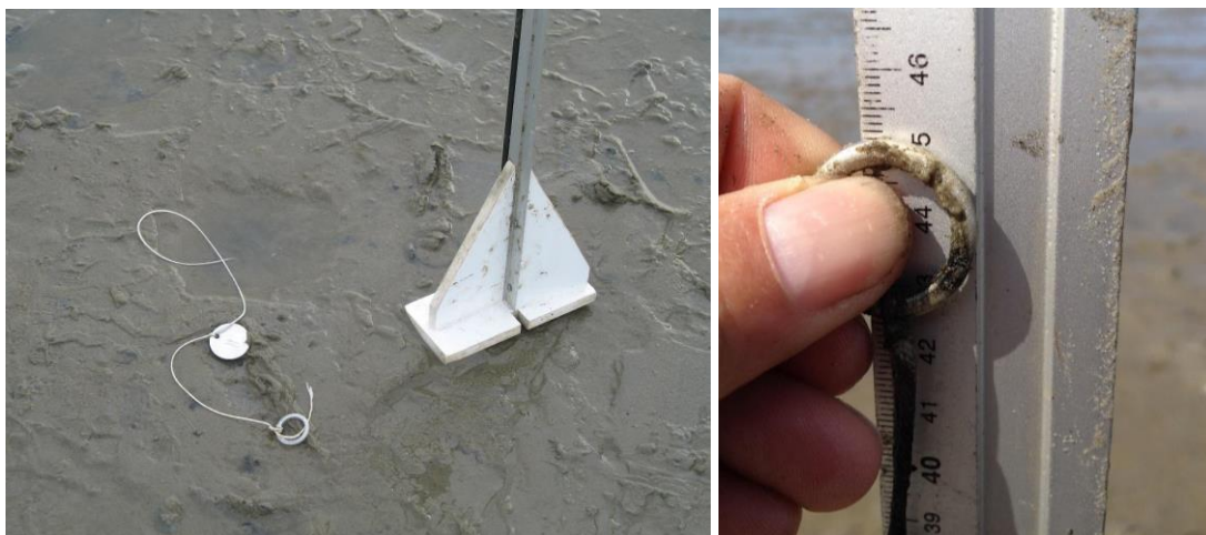
Figuur B2.2. Spijker meetmaterialen. Links: Meetliniaal met meetvoet. Deze wordt steeds op dezelfde wijze op de bodem gezet, waarna de lengte van het meettouw langs de schaal wordt afgelezen. Rechts: Aflezing van een meting tussen de bodem en de bovenkant van een ring. In dit geval 45,1 cm.
