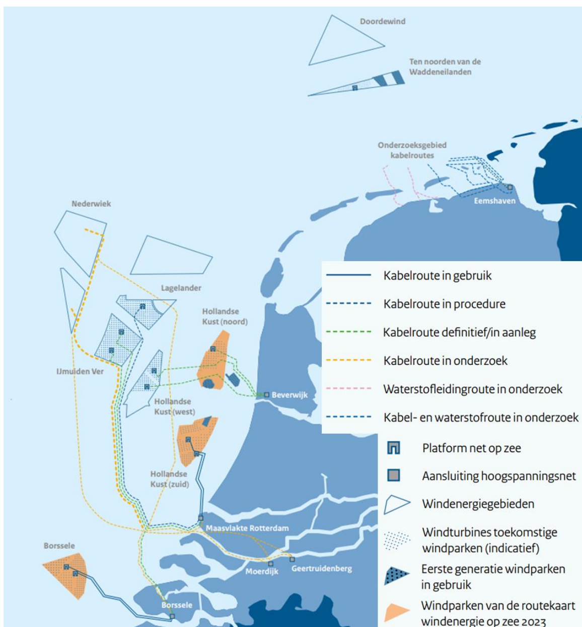
Figuur 7 Kaart van kabelroutes van het net op zee (Routekaart Windenergie op Zee, versie april 2023; https://www.noordzeeloket.nl/functies-gebruik/windenergie/net-zee/ )
