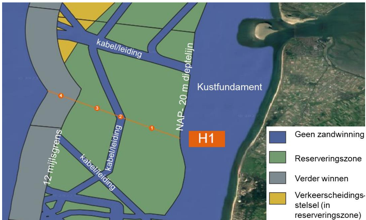
Figuur 4 Boveenaanzicht van het scenario 'Verder varen' voor de Noord-Hollandse kust (gebied H1). Winning gebeurt zo dicht mogelijk (1) maar verplaatst steeds verder weg als deze uitgeput raakt (3,4). In sommige zones kan (nog) geen zandwinning plaatsvinden omdat deze zone bijvoorbeeld voor kabels en leidingen is gereserveerd (2).
