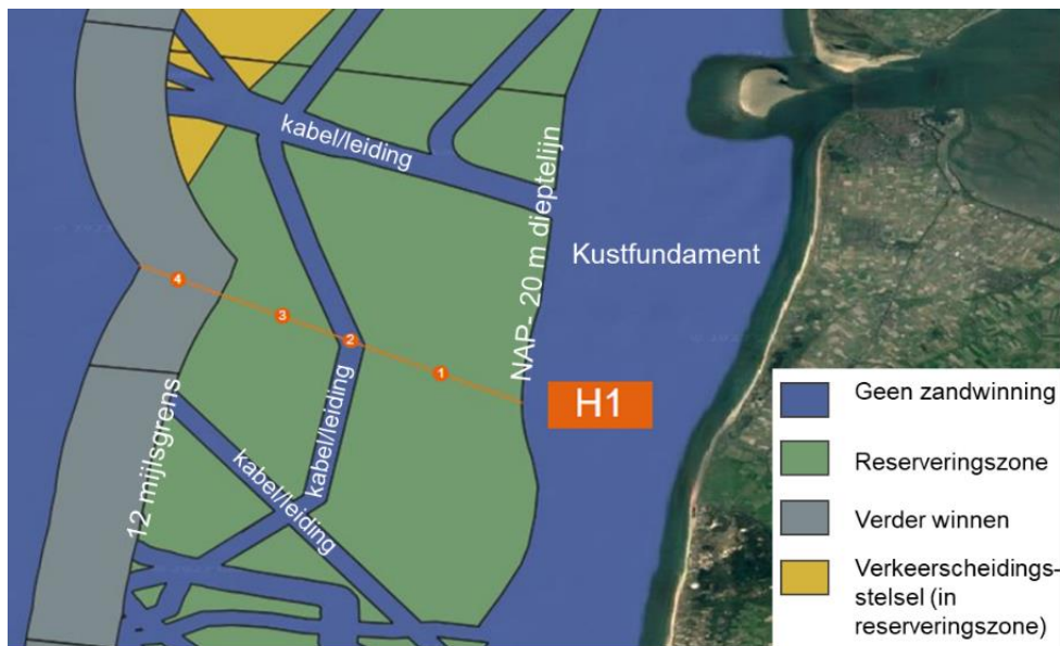
Figuur 11 Bovenaanzicht van het scenario 'Verder varen'. Winning gebeurt zo dicht mogelijk bij de kust (1) maar verplaatst steeds verder weg als deze zone uitgeput raakt (3,4). In sommige zones kan (nog) geen zandwinning plaatsvinden omdat deze zone bijvoorbeeld voor kabels en leidingen is gereserveerd (2).
