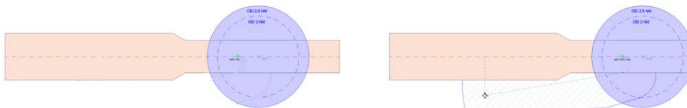
Figure 2: Links het ruimtebeslag van een PinS procedure voor één platform. Rechts met een alternatieve “missed approach” procedure
