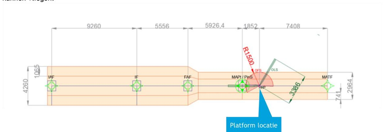
Figure 4: Horizontaal ruimtebeslag OFS en PinS
