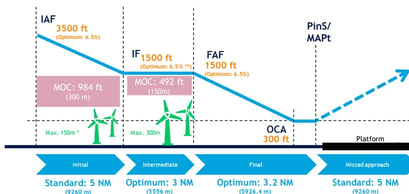
Figure 6: Vluchtfases nadering: initiële fase - tussenfase - laatste fase en afgebroken nadering
