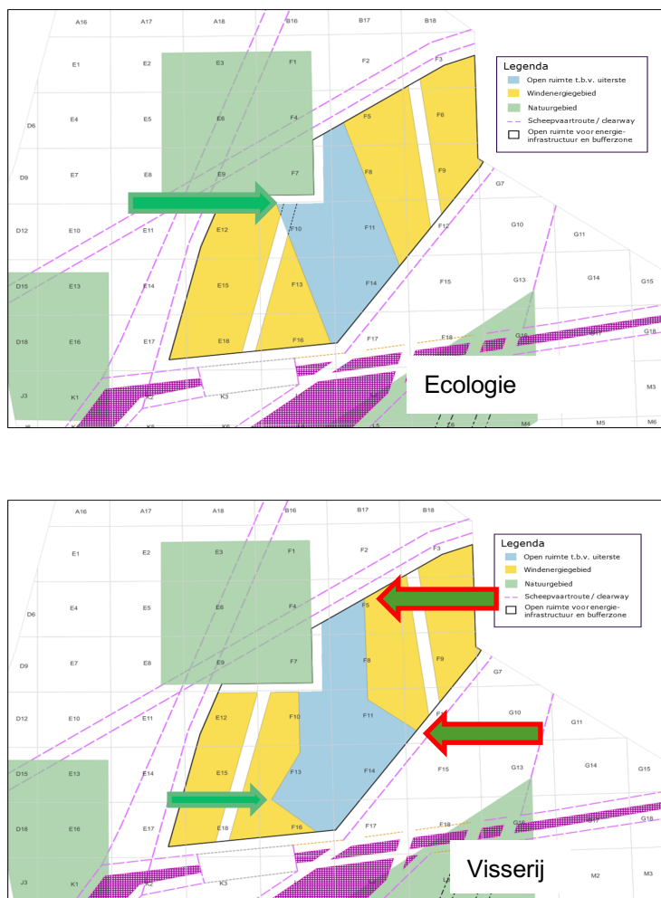
Figuur B4.2 Verschillen in vorm en ligging van open ruimte tussen de uitersten ecologie (boven) en visserij (onder). De pijlen verwijzen naar 'hoeken' in de open ruimte: zie uitleg in de hoofdttekst.
