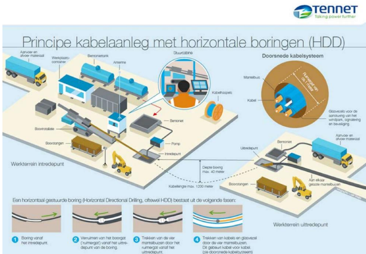
Figuur 8. Situatieschets intredepunt HDD-boring (bron: Tennet TSO).
