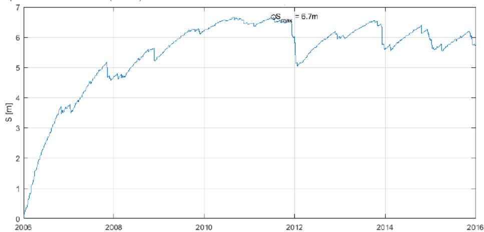
Figuur 5.20 Gemodelleerde ontwikkeling van de diepte van een ontgrondingskuil (S) in de tijd voor een fundering in het windpark Hollandse Kust (noord).
