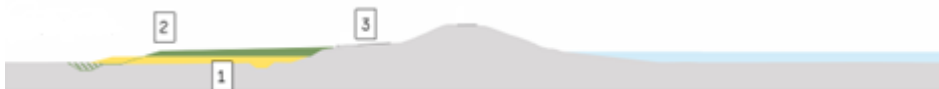
Figuur 5.12. Globale fasering Binnenwaarts. 1: voorbereiden werkbaan. 2 realiseren bermverbreding. 3: Herstellen N518. N.B.: dimensionering bermverbreding is niet op schaal.
