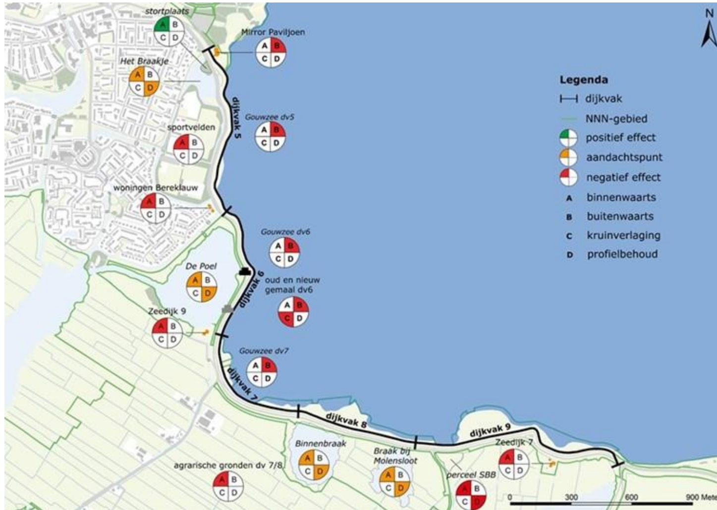
Figuur 6.13. Overzicht onderscheidende verschillen dijkvakken.
