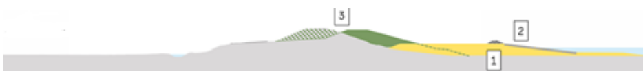
Figuur 5.17. Globale fasering Buitenwaarts. 1: voorbereiden werkbaan. 2: aanleggen tijdelijke kering. 3: realiseren asverschuiving. N.B.: dimensionering is niet op schaal.
