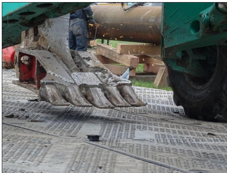
Figuur 3-3: Detail opname ripper shoe, tevens is onderste deel zwaard te zien (bron: Deltares, Inploegen grote diameter Leidingen).
