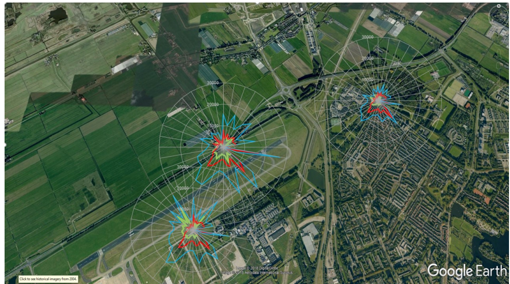
Figuur 14 De gemiddelde concentraties in de verschillende deeltjesgrootte klassen gemeten bij de verschillende windrichtingen. Groen (10-20 nm), rood (30-200 nm) en blauw (10-200 nm).
