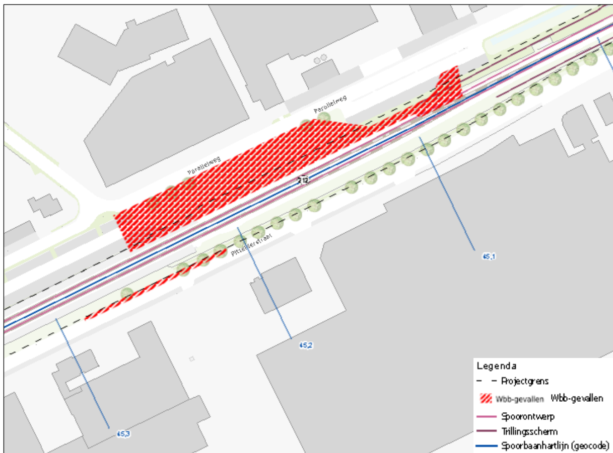
Figuur 13: Wbb-geval station Didam in relatie tot spoorontwerp en trillingschem.
