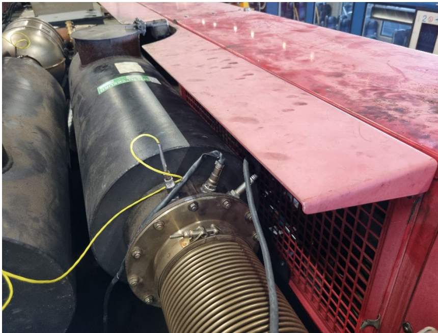
Figuur 3-1: De NO x /O 2 , NH 3 , en temperatuursensor, zoals deze gemonteerd waren in de uitlaat van de motor voor de demper op het dak van de trein.
