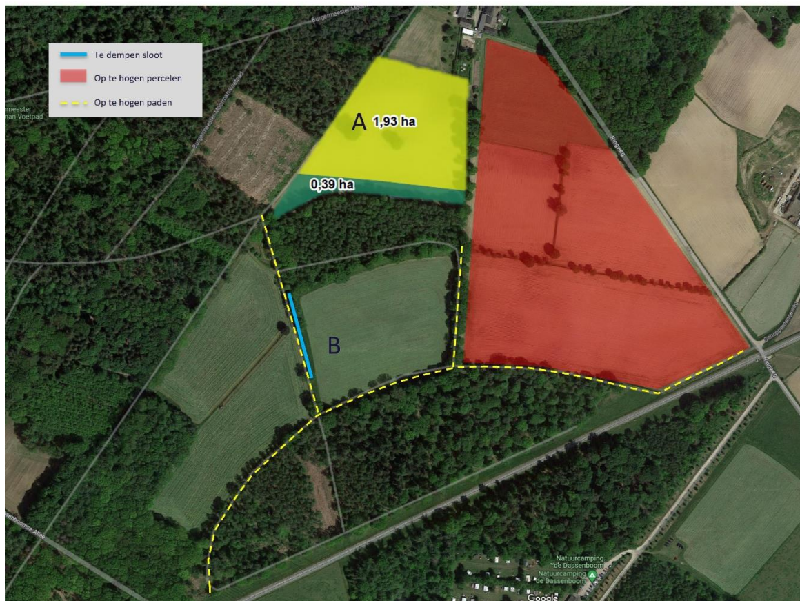
Figuur 1.8: Op te hogen paden, percelen en te dempen sloot rondom compensatiegebieden A en B (Bron: Bosgroep Midden Nederland).
