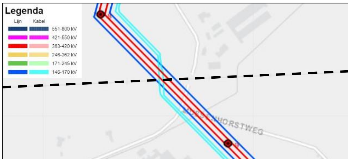
Figuur 42 Hoogspanningslijnen die het tracé kruisen (spoorlijn is zwarte onderbroken lijn)
