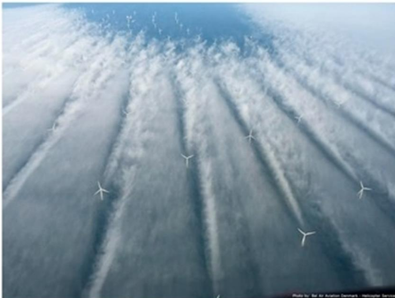
Figuur B3.5 In stabiele condities boven zee is het zog van windturbines in bijzondere omstandigheden goed zichtbaar
