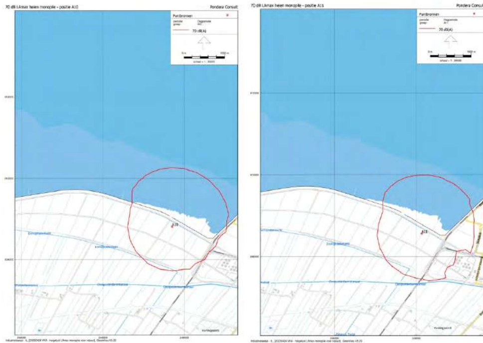
Figuur 16.3 Geluidscontour van 90 dB(A) voor de meest noordoostelijk geplande windturbines (van links naar rechts en van boven naar beneden WTG17 tot en met WTG22) van het VKA van Windpark Eemshaven-West (Bron: Flanderijn 2023).
