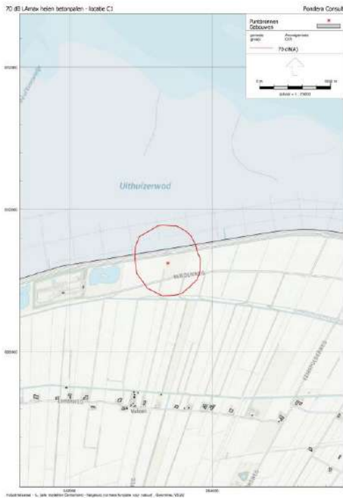
Figuur 8.3 Geluidscontour 70 dB(A) heien betonpalen, locatie C1
