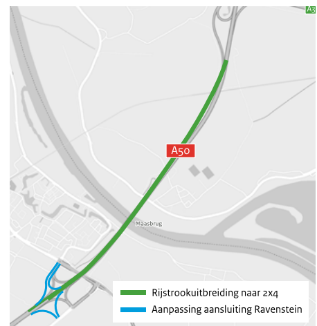
Figuur 12: Rijstrookuitbreiding naar 2x4
