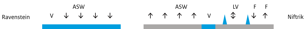
Figuur 11: Alternatief 10; indeling ter hoogte van de Maasbrug (V=vluchtstrook, ASW = autosnelweg, LV = langzaam verkeer, F = fietsverkeer)
