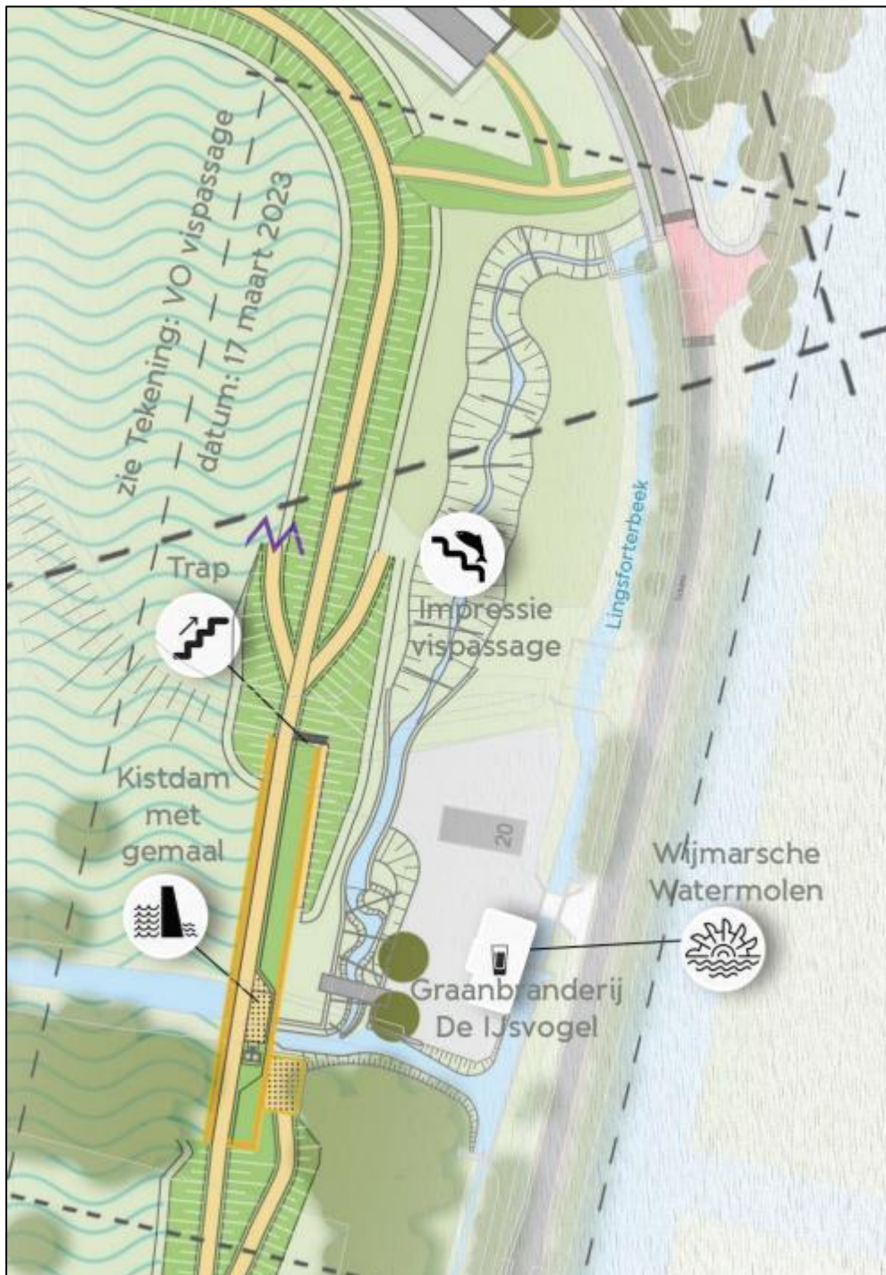
Figuur 6-7: Nieuwe dijktracé (zwart) met kistdam (geel omrand) en vispassage (boven, oranje) (uitsnede uit Bijlage I)
