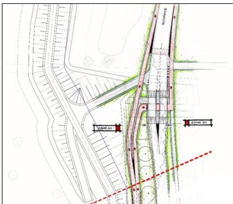
Figuur 4-19: Schets snelheidsremmend plateau bij de komgrens van Arcen.
