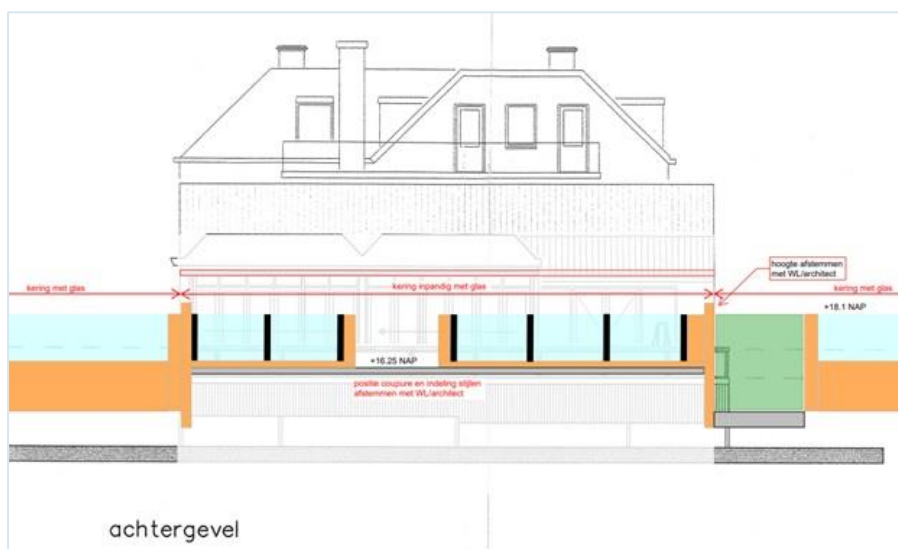
Figuur 6-12: Impressie van de te integreren glazen kering bij Brasserie Alt Arce
