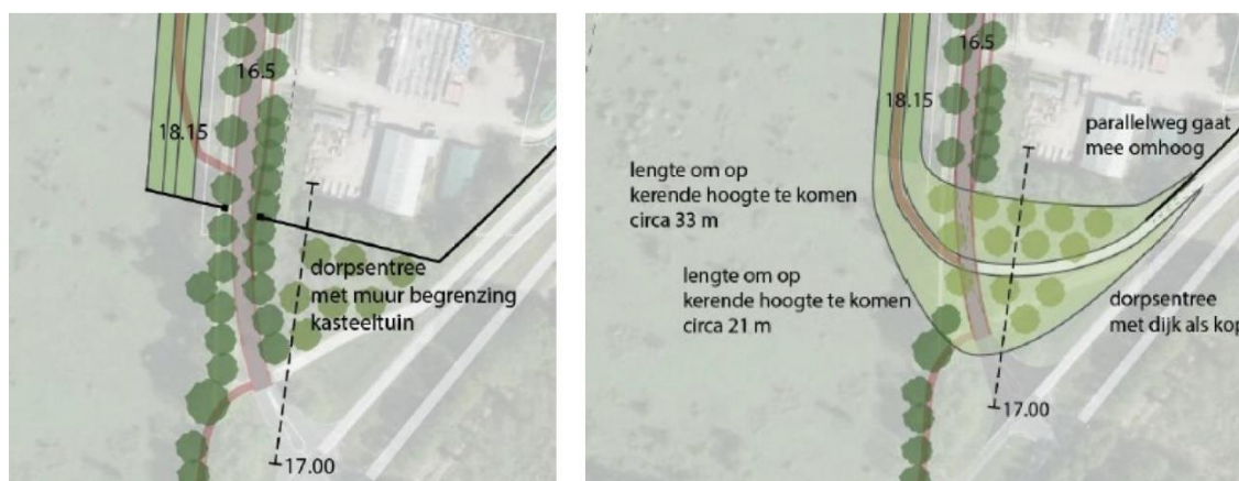
Figuur 4-6: Beschouwde oplossingen zuidpunt: keermuur met coupure (links) en 'groene kop' (rechts).
