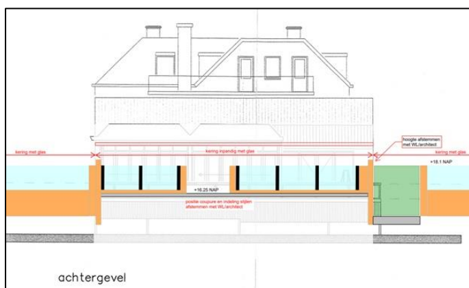
Figuur 4-26: Impressie van de te integreren glazen kering bij Brasserie Alt Arce.
