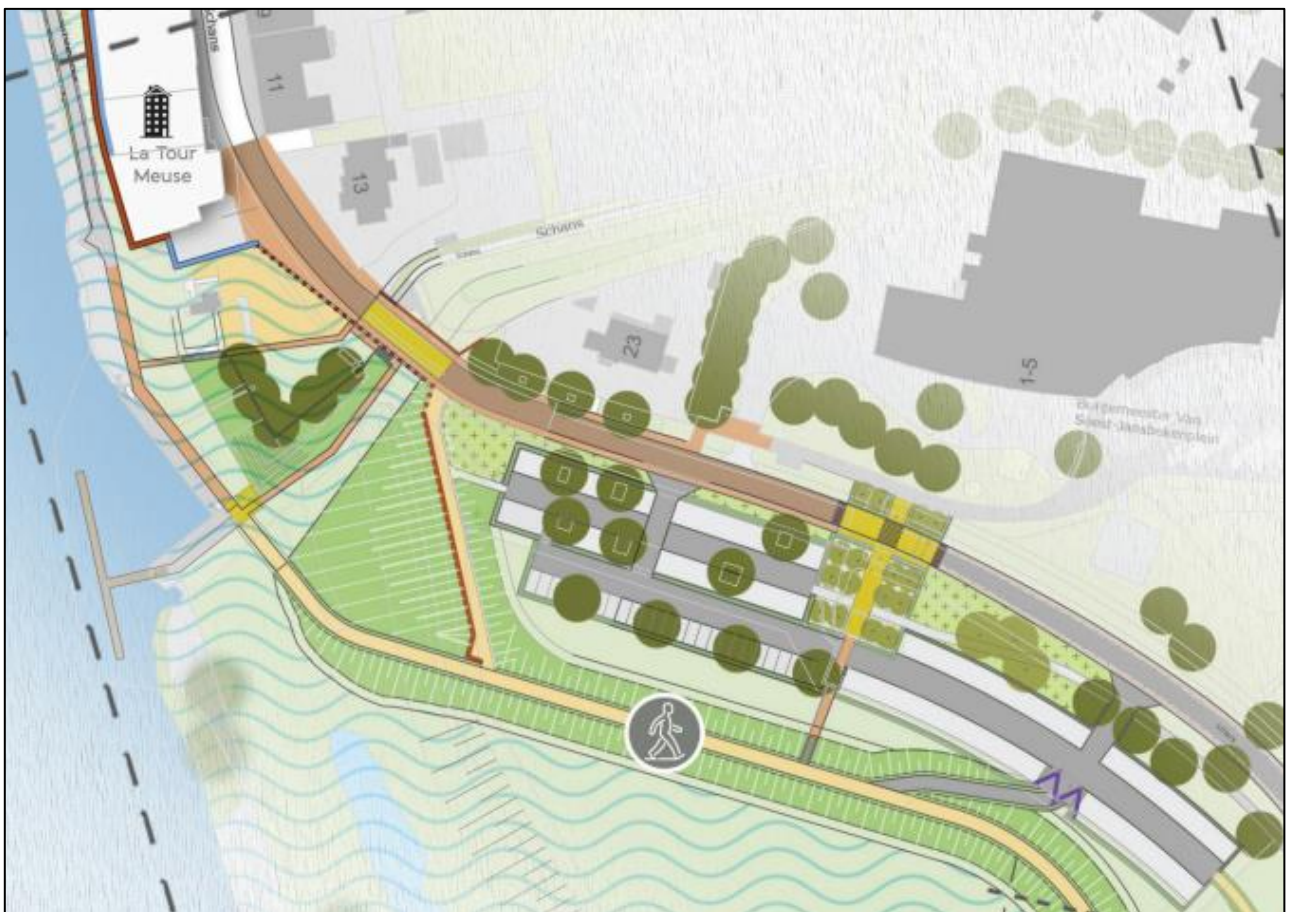
Figuur 6-9: Gronddijk parallel aan de parkeerplaats aan de Schans en Schanstorenplein (uitsnede uit Bijlage I)
