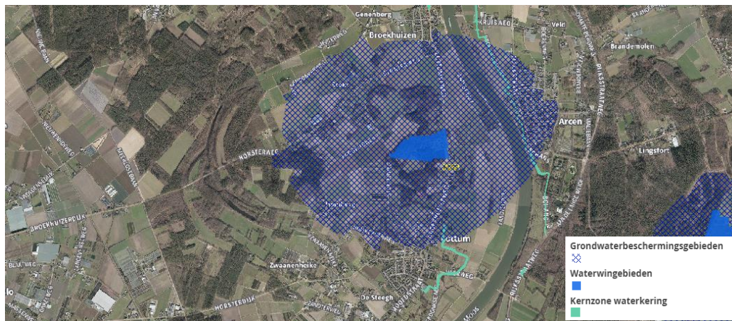
Figuur 2.2: Situering grondwaterbeschermingsgebieden en waterwingebieden ten opzichte van bestaande waterkering (bron: www.limburg.nl ).
