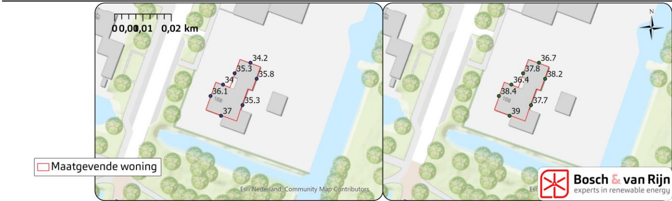
Figuur 53 Geluidsbelasting op de gevels in dB Lden van VKA onder (links) en VKA boven (rechts) - Meentweg 168 De Meern
