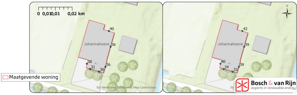
Figuur 56 Geluidsbelasting op de gevels in dB Lden van VKA onder (links) en VKA boven (rechts) - Ringkade 7 Utrecht
