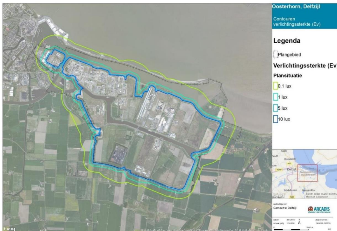
Figuur 16-1: Contouren van verlichtingssterkte bij volledige invulling van het industrieterrein (bron: MER industrieterrein Oosterhorn/Arcadis)
