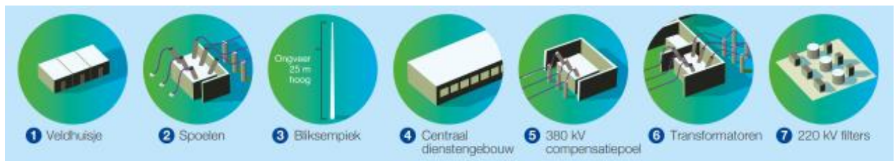
Afbeelding 33. Indicatieve weergave van onderdelen transformatorstation
