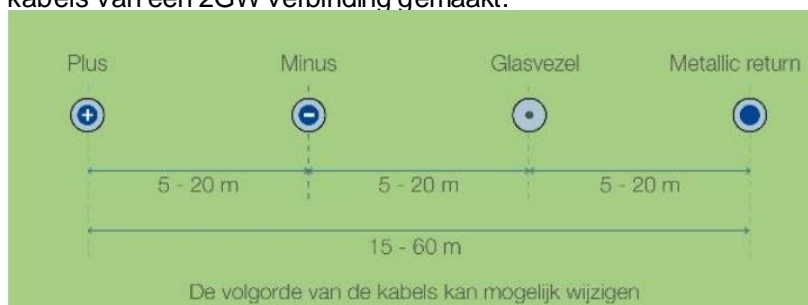
Afbeelding 31b. Een 2 GW-kabelsysteem HDD-kruising primaire waterkering
