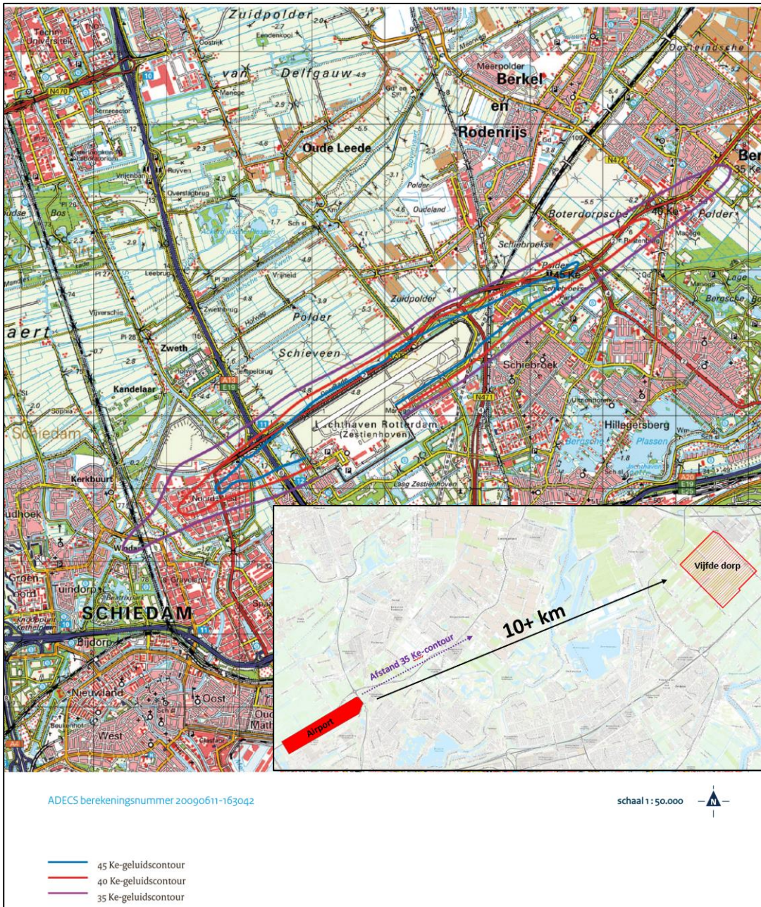
Figuur 2-7 De geluidcontouren van 'Rotterdam The Hague Airport uit de Omzettingsregeling luchthaven Rotterdam The Hague Airport.
