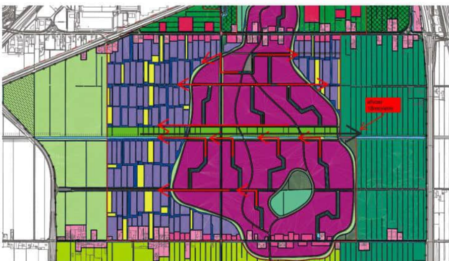
Afbeelding 4.6 Interne piekafvoer (en piekberging) via Tussentochten. Rode pijlen: stroomrichting tijdens piekbui. Zwarte pijlen: stroomrichting landelijke afvoer
