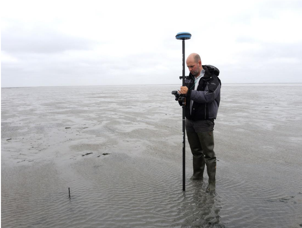
Figuur 28. Met DGPS inmeten van station P140 op het wad bij Paesens. Aan de onderkant van de staf is een rooster gemonteerd dat perfect op de wadbodem aansluit en niet wegzakt. De hoogte is ingemeten op de plaats waar het meettouw recht boven het grondanker uit de bodem komt. 2 september 2013. Foto J. Krol.
