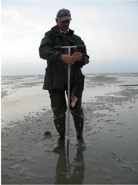
Figuur 2. Grote T-grondboor met dop aan uiteinde waarmee grondanker in de bodem geschroefd wordt. Het meettouw loopt door de grondboor en hieraan wordt later een identificatieblikje en aluminium afleesring bevestigd.
