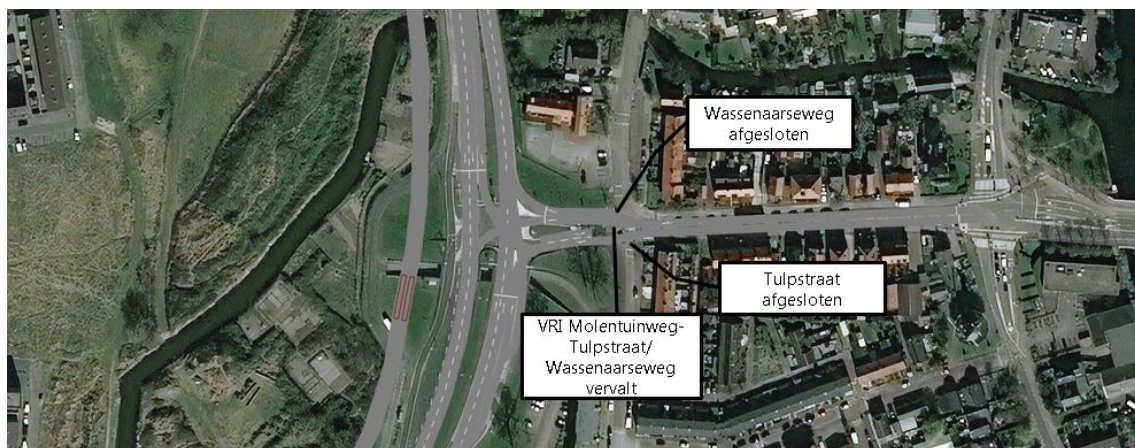
Figuur 5-24: Netwerkoverzicht afsluiting Tulpstraat en Wassenaarseweg
