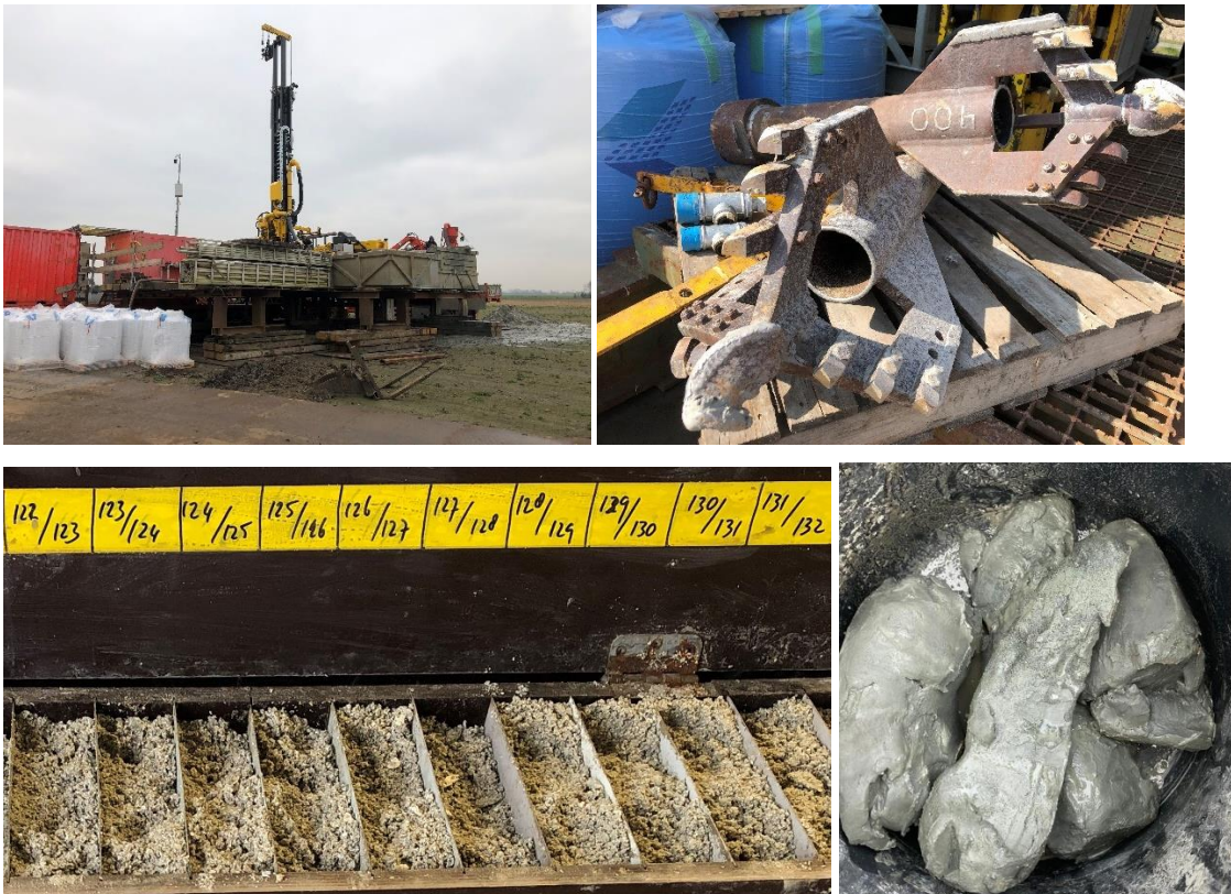
Figuur 8 Boven: boorstelling en gebruikte boorkoppen. Onder: gevulde boormonsterbak en opgeboorde Boomse klei.
