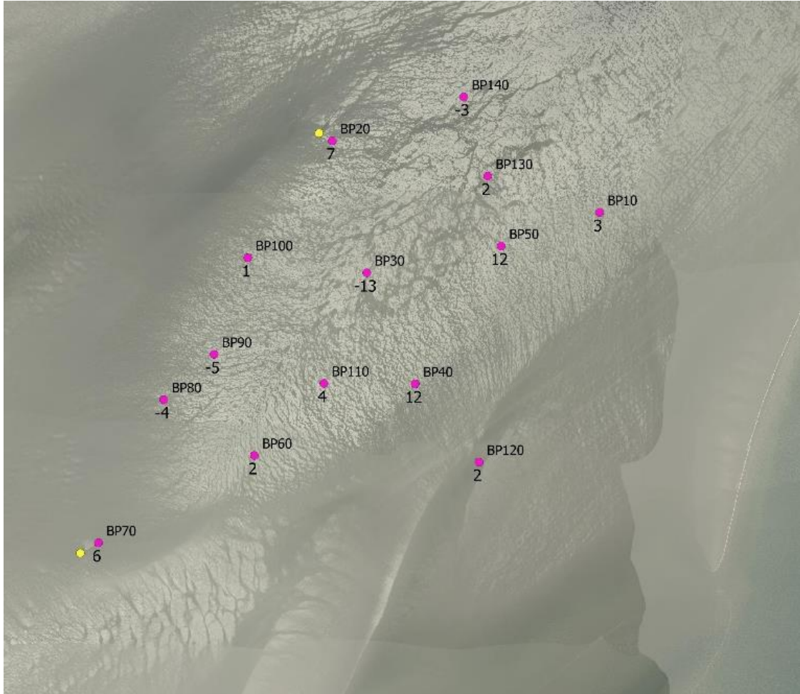
Figuur 4.3: Locaties van de meetstations op Ballastplaat (paarse punten) met bij ieder station de snelheid van sedimentatie (in mm per jaar) bijgewerkt t/m februari 2023. Met uitzondering van BP120 waar in september 2021 voor het laatst gemeten is.
