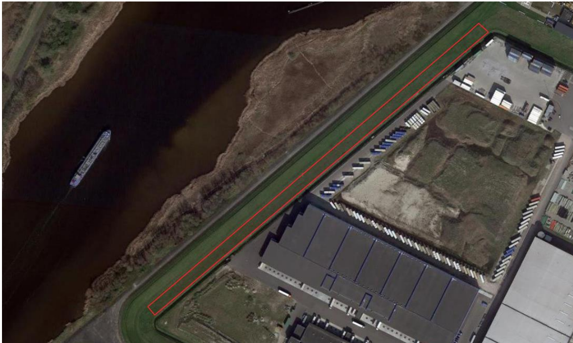
Afbeelding 4.1 Indicatief de locatie voor een toekomstige maatregel tegen piping, tussen binnenteen en sloot aan de binnenzijde van de dijk
