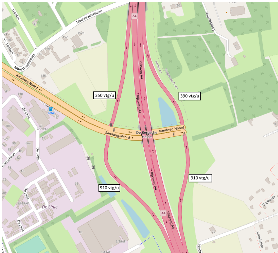
Afbeelding 4.1 Verkeersintensiteiten aansluiting Bergen op Zoom-Noord drukste uur gemiddelde werkdag (bron: INWEVA 2021)
