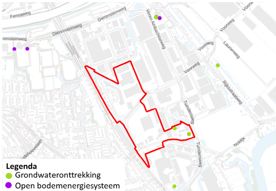
Figuur 3.9 Open bodemenergiesystemen en grondwateronttrekkingen (bron: WKO-tools)
