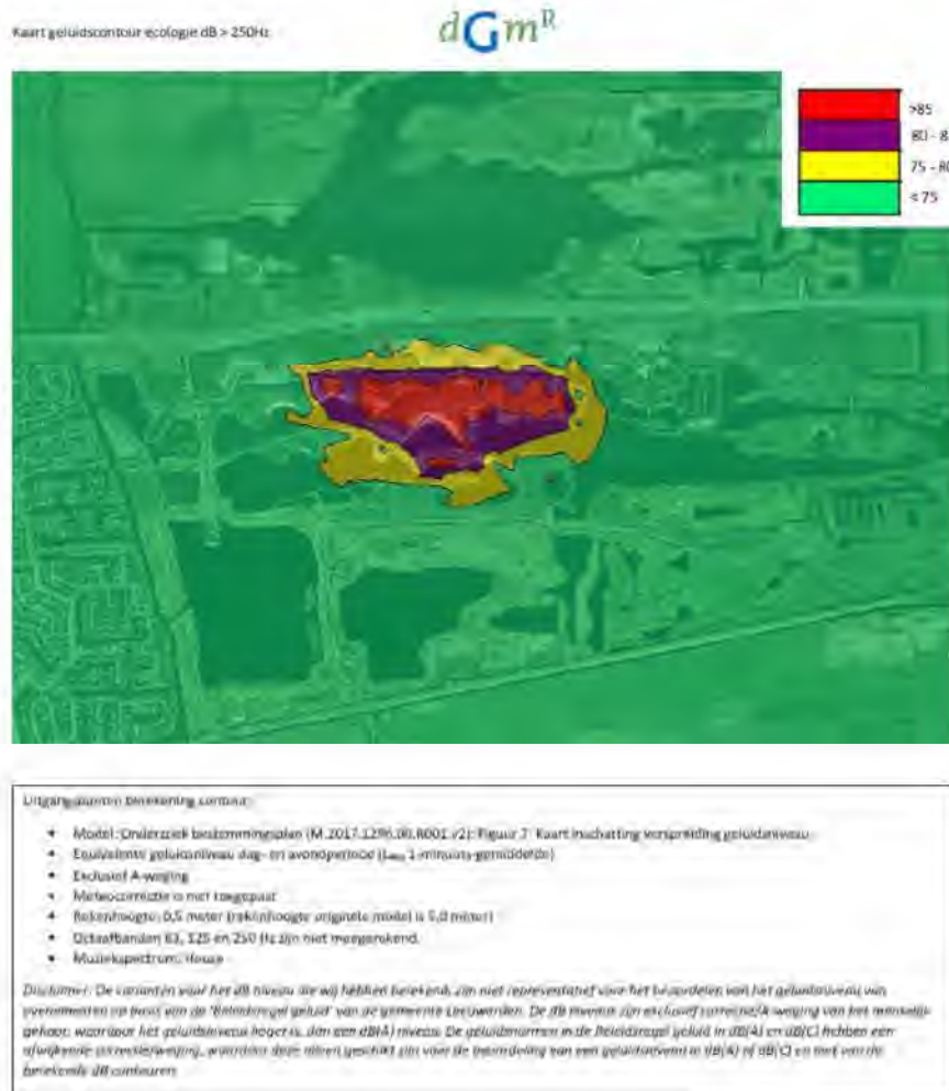
Figuur 3.2 Contouren van het festivalgeluid voor frequenties van 250 Hz en hoger in dB. Nergens binnen het Natura 2000-gebied is de geluidsterkte hoger dan 75 dB.
