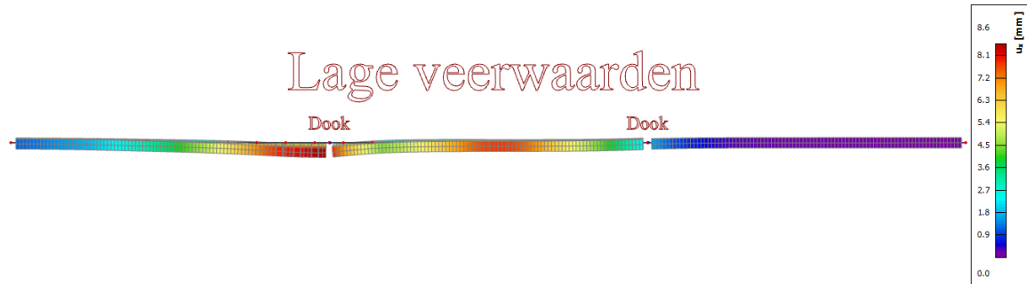
Afbeelding 6.2 Overzicht dwarsverplaatsingen kraanfundatiebalk
