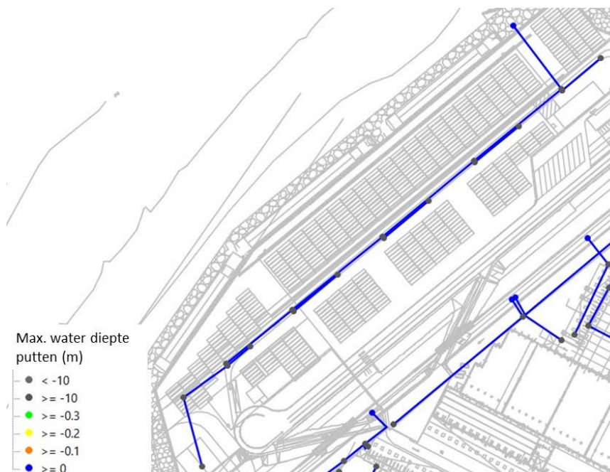
Afbeelding 3.5 Berekende stijghoogtes voor ontwerp HWA MCT bij standaard neerslaggebeurtenis 08
