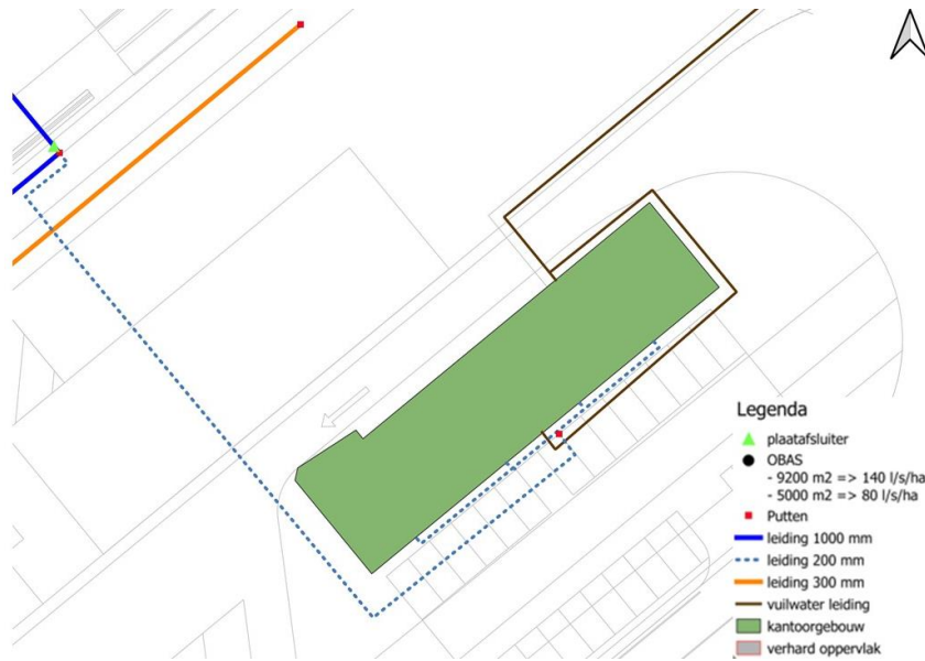
Afbeelding 3.4 Aansluiting HWA van het kantoor op hoofdafvoerleiding
