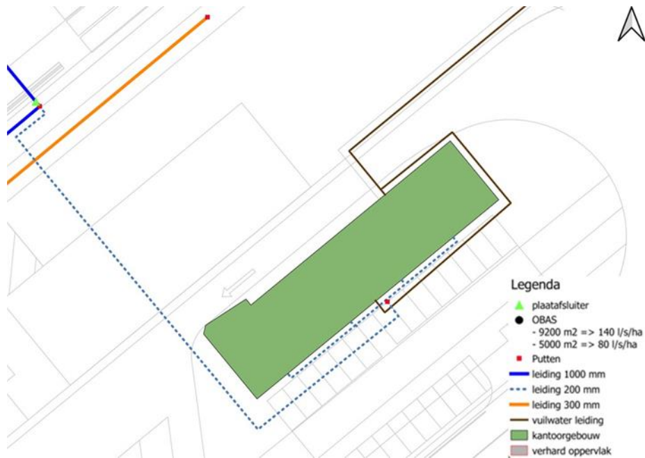
Afbeelding 3.6 Overzicht aansluiting VWA op afvoerleiding naar Noordland 12-16
