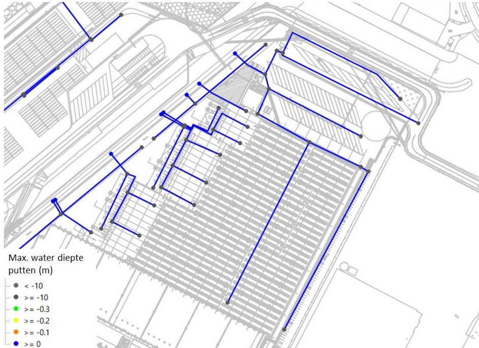
Afbeelding 4.8 Berekende stijghoogtes voor ontwerp HWA Noordland 14-15-16 bij standaard neerslaggebeurtenis 08
