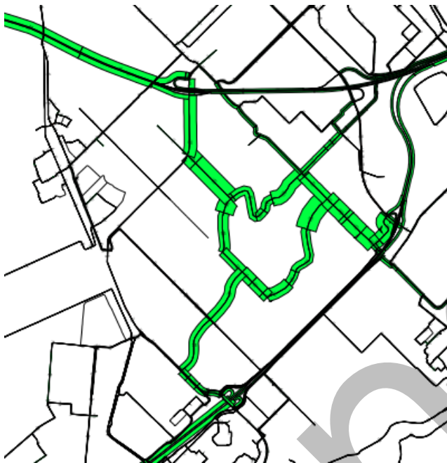
Figuur 4.5. | Effect van 15%-pakket: Alternatief Duurzame Mobiliteit ten opzichte van eerdere berekening (reguliere verkeersvraag). Verschilplot (aantal motorvoertuigen per etmaal). NB: de schaal van de balken is een andere dan die van de verschilplot in Figuur 4.4.
