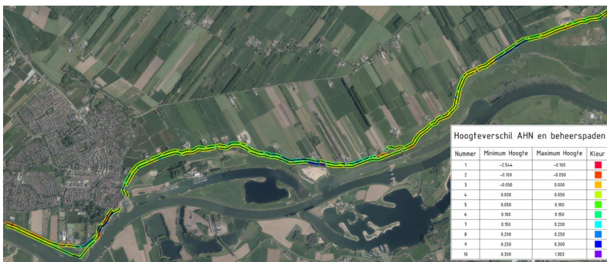
Figuur 2.2.1. Hoogteverschil tussen huidig AHN3 en de aan te leggen beheerspaden. Op basis van "Praatprent-052 versie 0.1".
