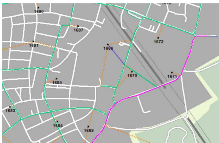
Figuur 3.4: Ontsluitingsstructuur Plan 3 2030: zone 1686, Mayr-Melnhof ontsluit voor auto's aan de oost- en zuidkant en voor zwaar vrachtverkeer (blauw) met een nieuwe ontsluiting
