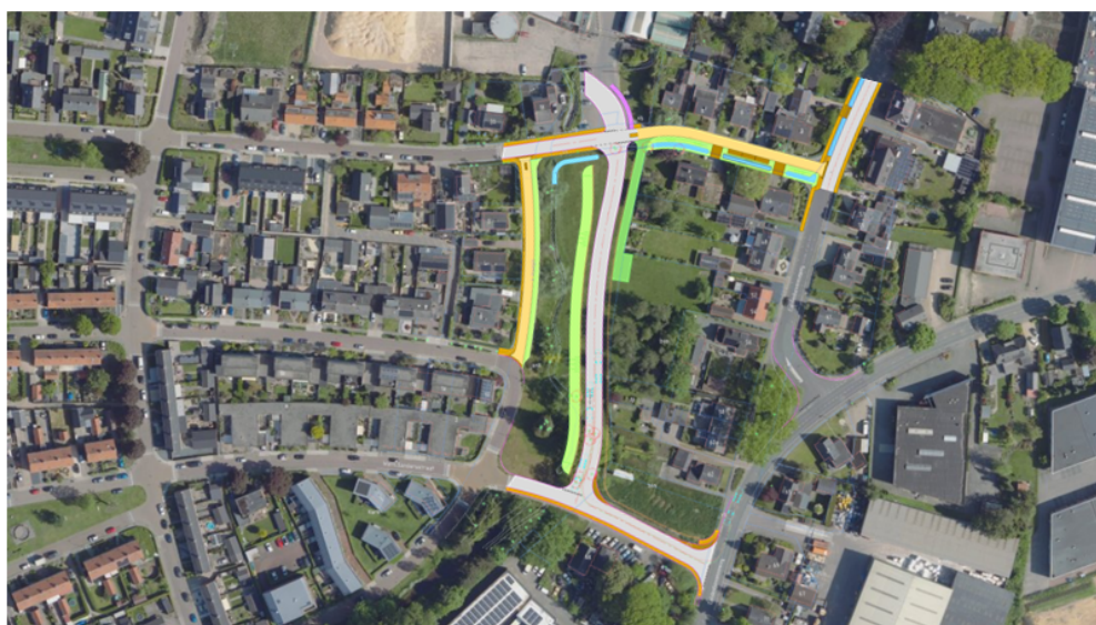
Figuur 3.2 Schetsontwerp van de infrastructuur-aanpassingen door de groenzone langs 't Haagje geprojecteerd op luchtfoto (Schetsontwerp Alternatief E4 met dubbele T-aansluiting, schetsontwerp Provincie Gelderland nr E4.01 d.d. 22-02-2022)
