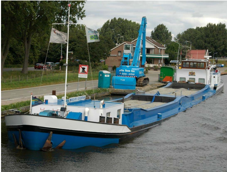
Figuur 4-18. Beunship voor de aanvoer van grond, zand en klei
