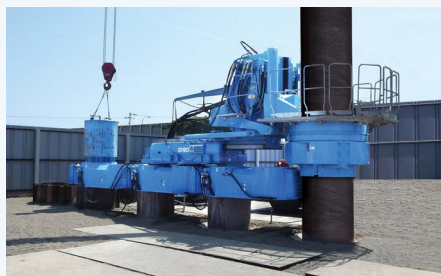
Gyropress voor boren buispalen
