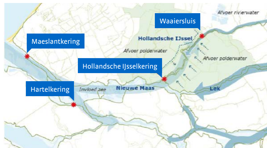
Figuur 3-4. Hoogwaterbeschermingssysteem Hollandsche IJssel
