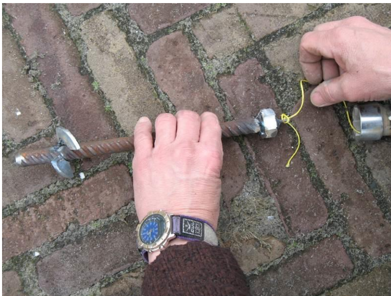
Figuur 1. Eigenbouw grondanker waaraan meettouw bevestigd wordt. Rechts de dop aan het uiteinde van de T-grondboor waarmee het anker in de bodem geschroefd wordt (zie figuur 2).
