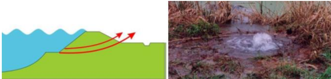
Figuur 2.3 Schematische weergave van piping als faalmechanisme ( helpdeskwater.nl ) en een voorbeeld van een zandvoerende wel
