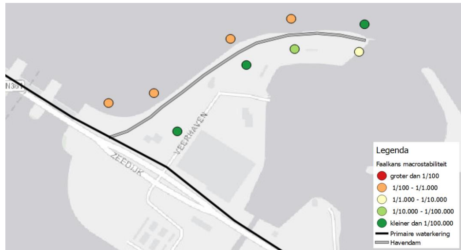
Figuur 114 Faalkans van de havendam voor stabiliteit bij de verschillende profielen 22 ,17, 15 en 6 (van rechts naar links). De meest linkse locatie geeft faalkans van de primaire waterkering voor STBU weer (Vak 1.1)
