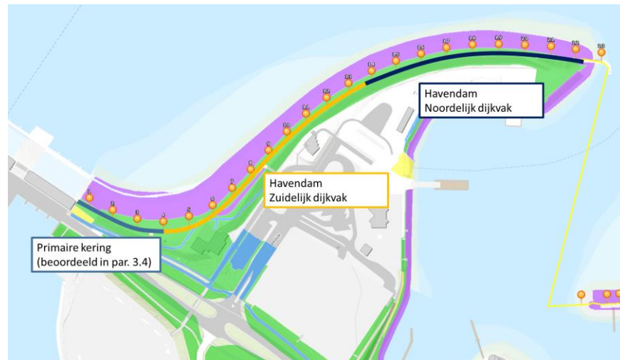
Figuur 116 Vakindeling ZST havendam (de paarse delen zijn zetsteen, gras is groen).
