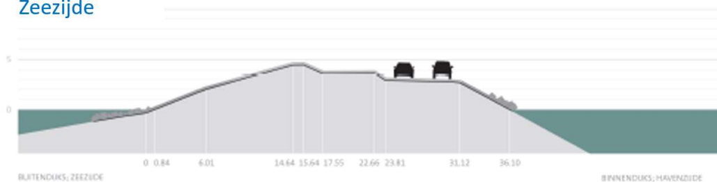
Figuur 7: Kenmerkend dwarsprofiel oostelijke havendam
