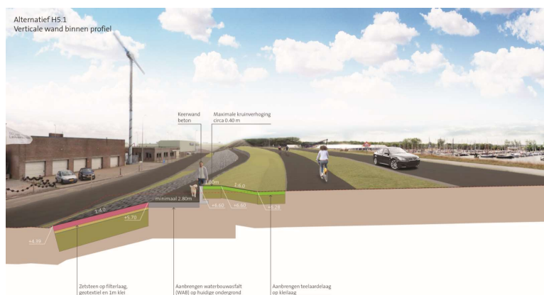
Figuur 5: Kansrijk alternatief havendijk H5.1 (verticale wand binnen profiel)
