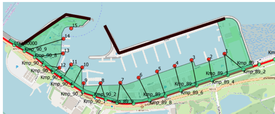
Figuur 27 Koppeling tussen dijpalen (groen) en uitvoerlocaties vanuit de haventool (rood) voor variant 1 en 3. Bij variant 3 is de oostelijke havendam niet meegenomen (zie Figuur 24). De koppeling is voor beide varianten gelijk.
