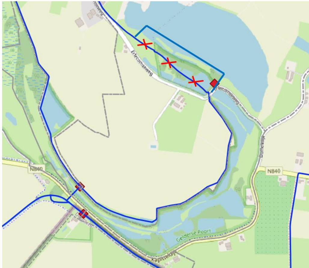
Uitsnede watersysteem Ooijpolder, met aanpassing van de Legger van WSRL De rode kruizen tonen de foutieve legger. De dikke blauwe lijn toont de daadwerkelijke verbinding.
