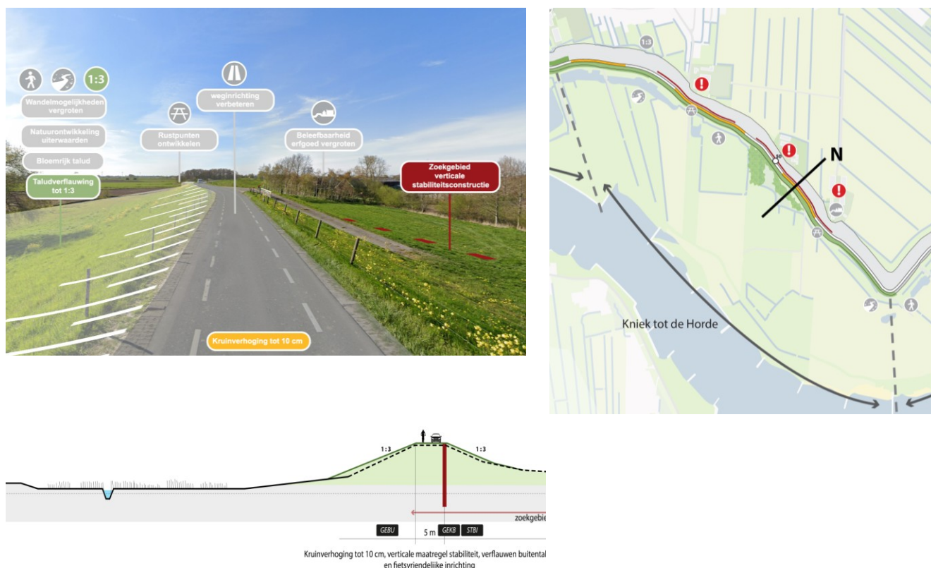
Figuur 3.18a-c. Beeldmontage, doorsnede van de dijk en een uitsnede van de kaart van deeltraject Kniek – de Horde.
