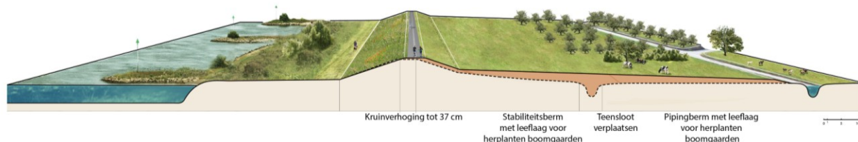
Figuur 6.4. Principe profiel van kansrijk alternatief 2.
