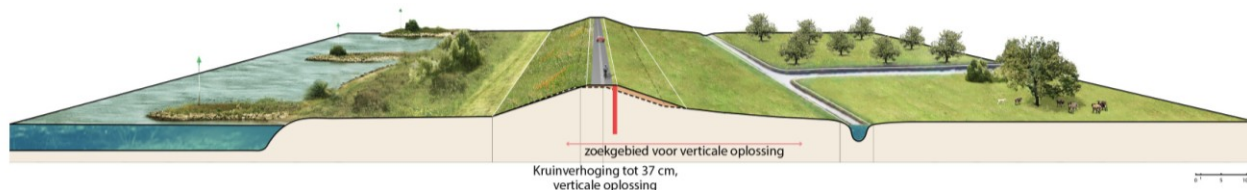
Figuur 6.1. Principe profiel van kansrijk alternatief 1.
